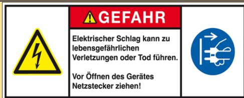
**⚠** Das Blitzsymbol mit Pfeilspitze in einem gleichseitigen Dreieck soll den Benutzer auf das vorrhandensein nicht isolierter „gefährlicher Spannung“ innerhalb des Produktgehäuses aufmerksam machen, die möglicherweise so groß ist, dass für Personen die Gefahr eines Stromschlags besteht!
